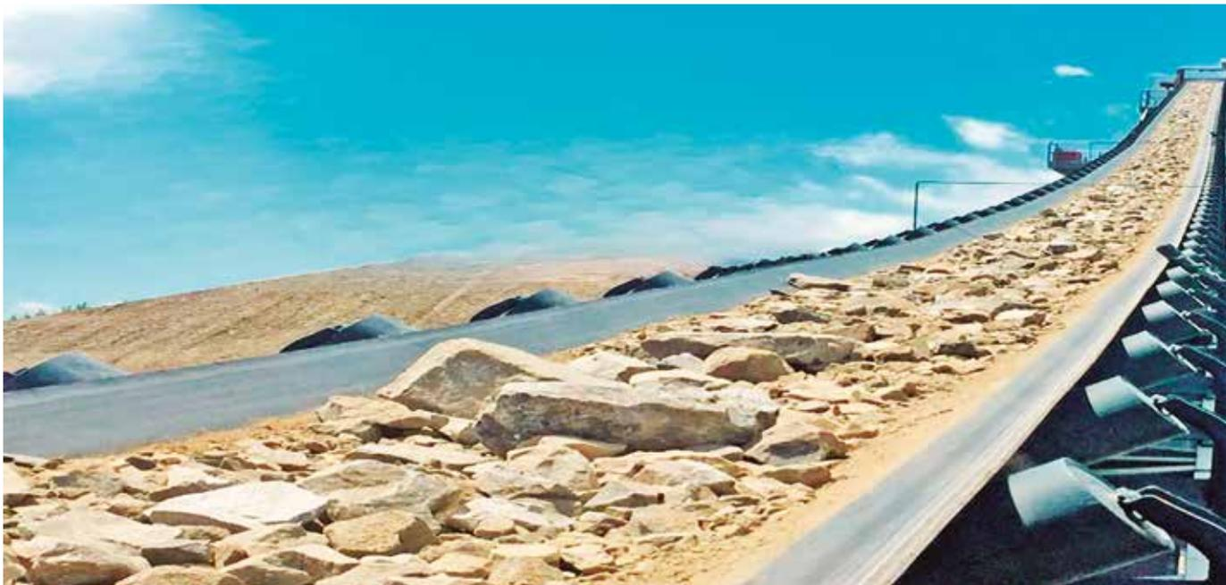
■ LAS TECNOLOGÍAS QUE SE HAN IMPLEMENTADO SON LOS SISTEMAS DE RX Y EQUIPOS DE MEDICIÓN DE ESPESORES, CON EL FIN DE CONOCER EL ESTADO INTERIOR DE LAS FAJAS Y ESPESOR DE LAS CUBIERTAS.
