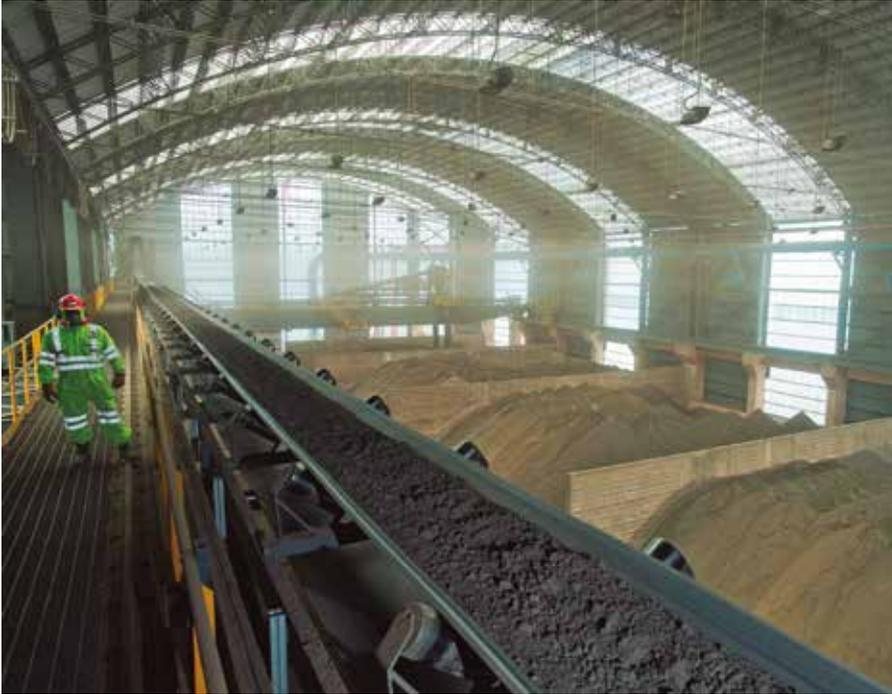
Los expertos aseguran que la industria minera siempre exige de sus bandas transportadoras dos requisitos: seguridad y confiabilidad. Seguridad porque existen entidades que supervisan el cumplimiento de las normas de seguridad en la actividad minera, lo que incluye la regulación de las cintas transportadoras y sus protecciones respectivas.
